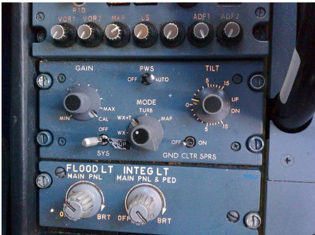
*Panel de control del radar del A321 con el sistema 1 activado, operando en modo WX + turbulencia, con la ganancia calibrada y la elevación de la antena un grado hacia arriba. La predicción de cizalladura (PWS) se encuentra en funcionamiento y la supresión de ecos del terreno desactivada.*
